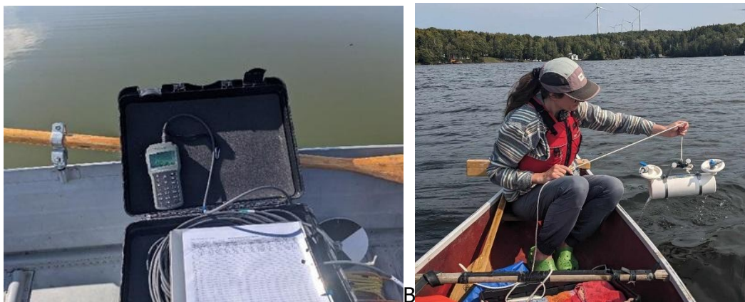
Figure 5: A) prise d'échantillon d'analyse d'eau et des profils avec la sonde Hanna, 2024 B) Bouteille d'échantillonnage d'eau horizontale
